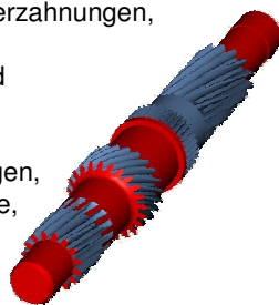
Vorgelegewelle mit Schrägverzahnung und Profilver-schiebung
